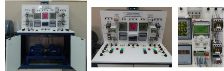
Станция для испытаний асинхронных тяговых двигателей локомотивов
